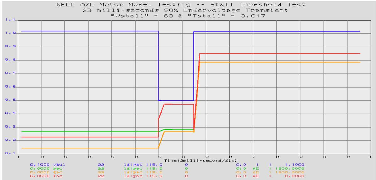
Figure 27. Stall Delay Time Test (23-ms 50 % UVsag)
