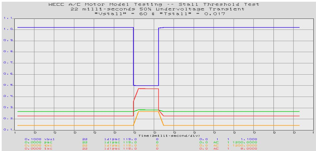
Figure 26. Stall Delay Time Test (22-ms 50 % UVsag)
