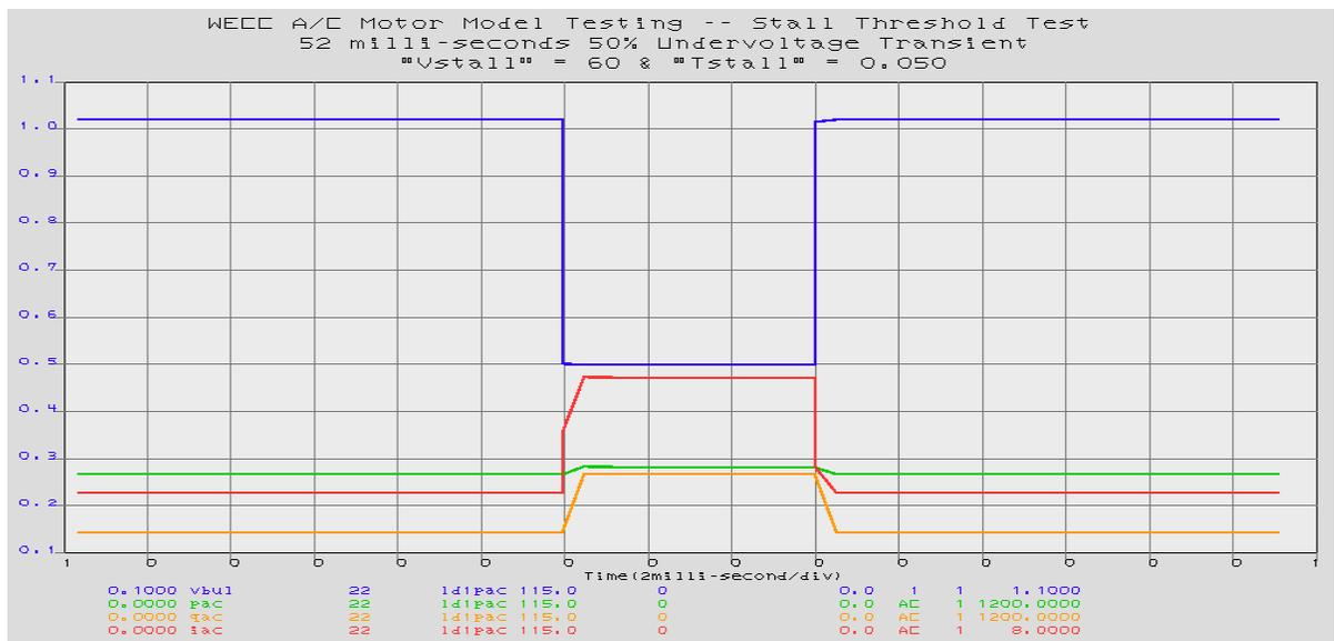
Figure 30. Stall Delay Time Test (52-ms 50 % UVsag)
