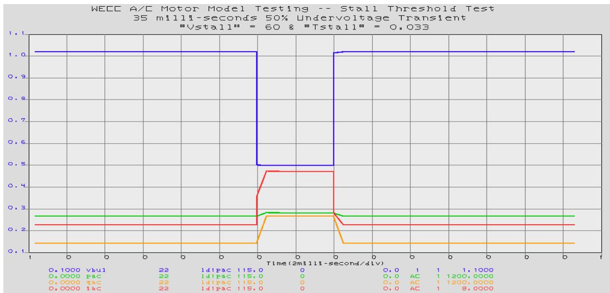
Figure 28. Stall Delay Time Test (35-ms 50 % UVsag)
