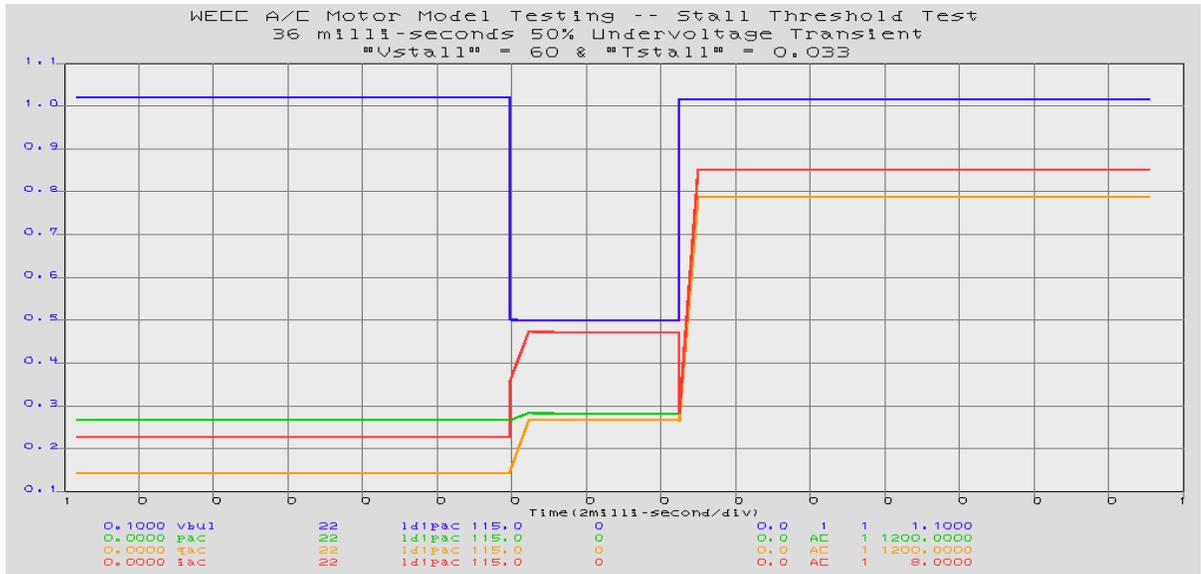
Figure 29. Stall Delay Time Test (36-ms 50 % UVsag)
