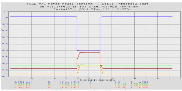
Figure 28. Stall Delay Time Test (35-ms 50 % UVsag)
