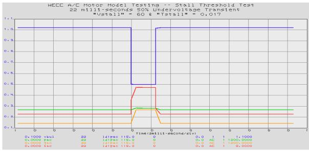
Figure 26. Stall Delay Time Test (22-ms 50 % UVsag)
