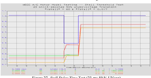
Figure 27. Stall Delay Time Test (23-ms 50 % UVsag)
