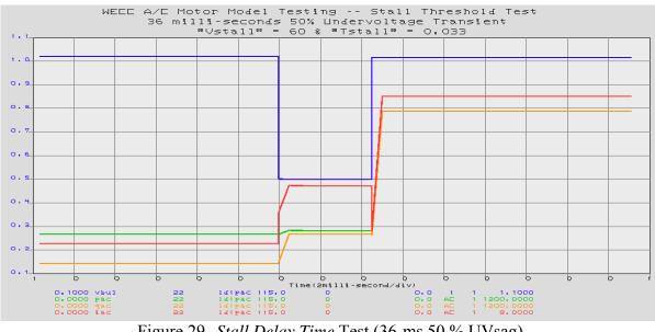
Figure 29. Stall Delay Time Test (36-ms 50 % UVsag)
