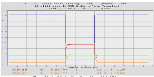
Figure 30. Stall Delay Time Test (52-ms 50 % UVsag)
