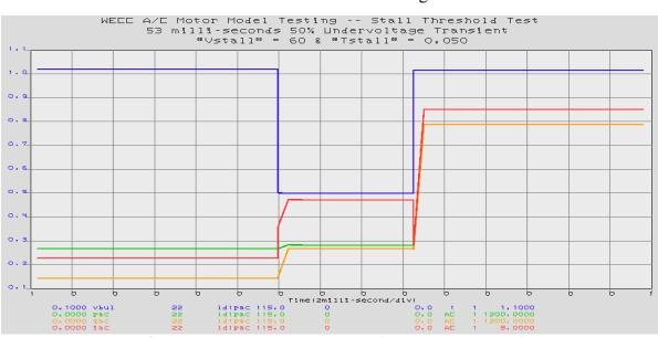
Figure 31. Stall Delay Time Test (53-ms 50 % UVsag)
